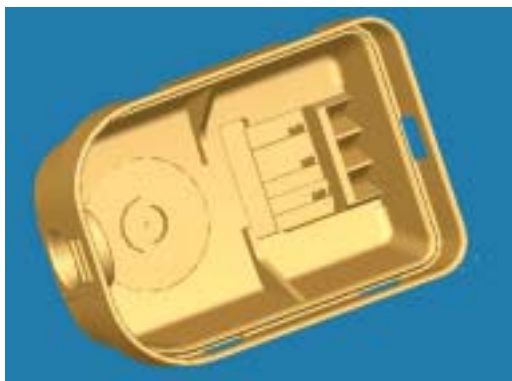
Figure 23 : modification de la géométrie de la pièce avec la création de deux berrures
